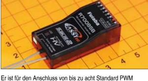
Servos (Analog oder Digital) ausgelegt. Mit zwei Empfängern können bis zu 16 Kanäle empfangen werden. Am S-BUS Ausgang stehen alle Kanäle auch in digitaler Form zur Verfügung. Dort können direkt bis zu 18 S-BUS Servos oder mittels Adapter auch Standard PWM Servos angeschlossen werden.
